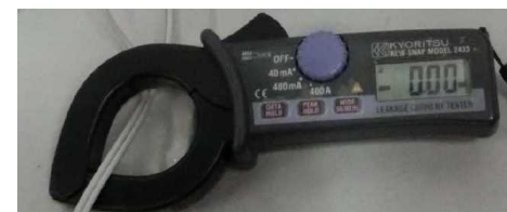
漏れ電流測定 ダイヤル位置はmA
