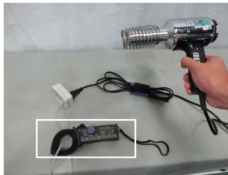
漏れ電流測定 ダイヤル位置はmA
